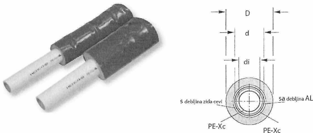
Slika 1: Oznake glavnih mera cevi PE-Xc/AL/PE-Xc sa predizolacijom
